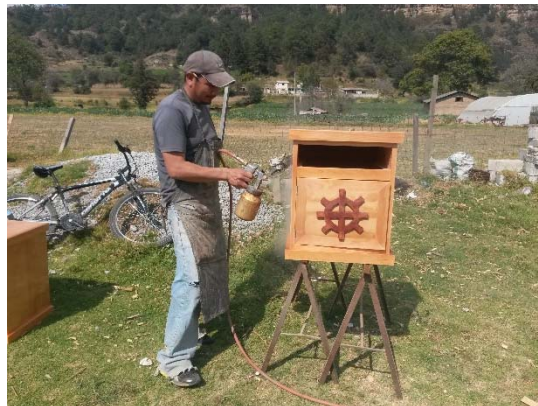
Foto 28. Aplicación de pintura
